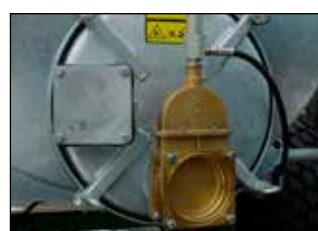
Standard manhole (Ø 600 mm)
